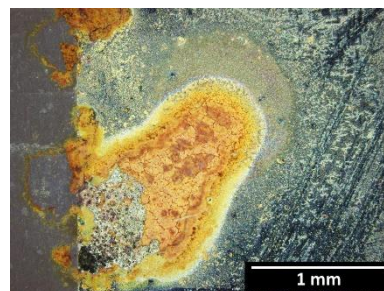
鋼の表面に生じた腐食の観察
