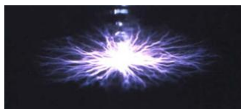
図3 水上パルス沿面放電の静止写真
