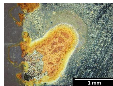
鋼の表面に生じた腐食の観察
