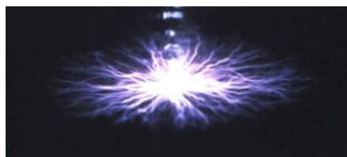
図3 水上パルス沿面放電の静止写真
