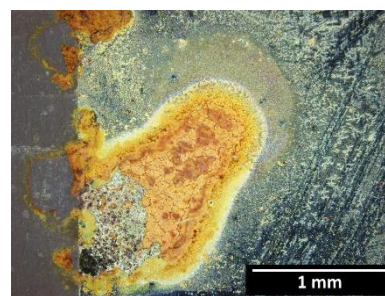
鋼の表面に生じた腐食の観察
