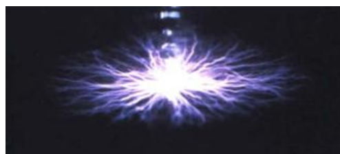
図3 水上パルス沿面放電の静止写真
