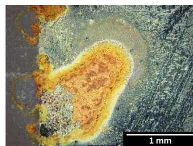
鋼の表面に生じた腐食の観察
