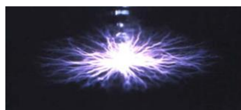
図3 水上パルス沿面放電の静止写真
