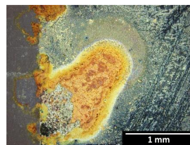
鋼の表面に生じた腐食の観察
