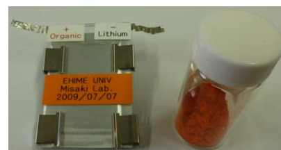
図：有機材料を正極活物質として用いた試作電池と活物質分子の試料
