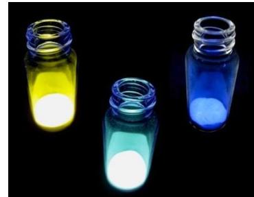
図：開発したレアアースフリー蛍光体(紫外線照射により可視光線を発生する)
