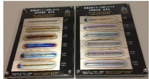
図：シールドガス中の酸素含有量を制御し、適切にチタン表面のみを酸化させた溶金部の色見本
