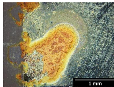
鋼の表面に生じた腐食の観察
