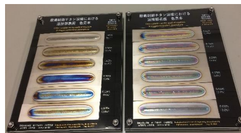
図：シールドガス中の酸素含有量を制御し、適切にチタン表面のみを酸化させた溶接部の色見本
