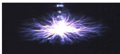
図3 水上パルス沿面放電の静止写真
